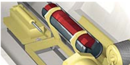
Hydraulikwagen zur Umlagerung des Metallbehälters
